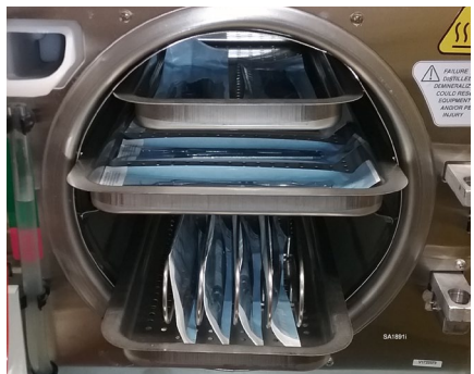
M11: Bolsas con bandejas y separador de bolsas Imagen 8
