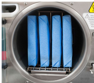
M11: Con separador de cajas vertical opcional Imagen 12
